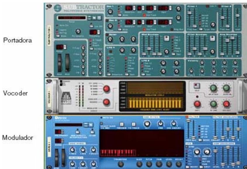
6. Gire o rack e conecte a saída do Dr. Rex ao conector de entrada Modulador do BV512.
