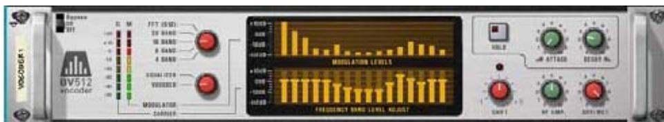
O BV512 é um avançado dispositivo vocoder com número de bandas de filtro variável. Também possui um exclusivo modo de vocoder de 1024 pontos FFT (equivalente a 512 bandas de vocoder) para oferecer efeitos de vozes vocoder de altíssima qualidade. Ao conectarmos o BV512 a dois dispositivos de instrumento podemos produzir qualquer tipo de som a partir de uma típica voz ou bateria vocoder até incríveis efeitos especiais.
